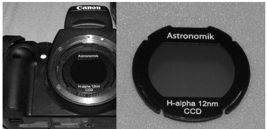
Abbi. 1: So rastet ein Clipfilter in das Bajonett der Canon EOS 350D ein
